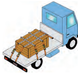
Schrägzurren in Längs- und Querrichtung
