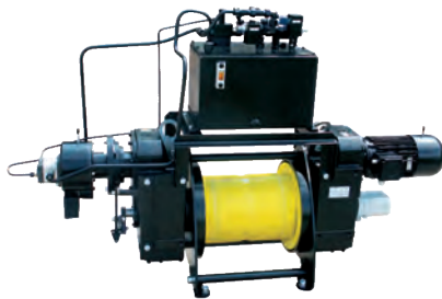
BETA-Winde mit hydraulischem Bremssystem zum kontrollierten Ablassen der Last beim Freischalten der Seiltrommel
