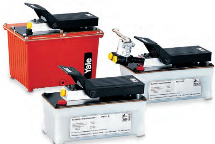
Die Pumpen für doppeltwirkende Hydraulikzylinder verfügen zusätzlich über ein 4-Wegeventil VHH-4/3. Die Steuerung des angeschlossenen Hydraulikzylinders (Ausfahren - Halt - Einfahren) erfolgt durch die aufgebaute Wippe, die sowohl per Hand als auch mit dem Fuß bedient werden kann.
