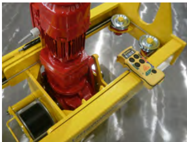
Elektromotorisch angetriebene Gurtrollen.
