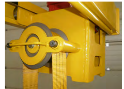
Stufenlos verstellbare Greifweite mit Elektromotor.
