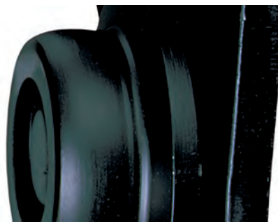
Laufrad mit balligem Profil
