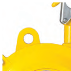
Öse für Sicherheitskette Nach DIN 15112 muss der Balancer mit einer zusätzlichen Sicherheitskette befestigt werden.
