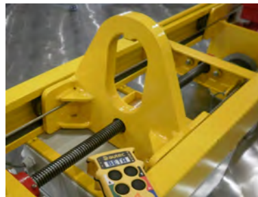
Mittelöse zum Lastausgleich elektronisch fahrbar.
