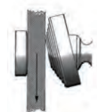
Abb. 3 FALSCH! Die Klemmkraft wird durch zu festes Anziehen der Spindel keineswegs erhöht! Denn die Gegenocke kann sich dadurch nicht mehr optimal an die Last anpassen. Das führt zu einer vorzeitigen Alterung der Verzahnung und des Gelenks.
