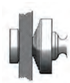
Abb. 1 Durch Anziehen der Spindel mit normaler Handkraft wird die Gegenocke sicher am zu hebenden Gut angeedrückt.
