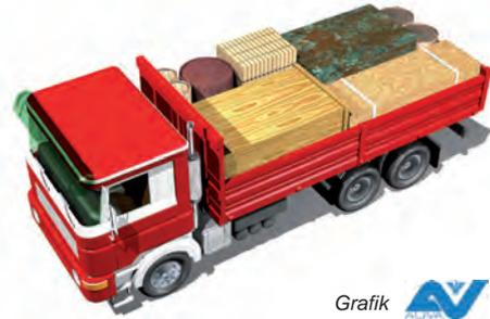
Das Blockieren einer instabilen Ladung ohne die Verwendung von Zurrmitteln ist nur möglich, wenn die Blockierung den Schwerpunkt der Ladung abstützt. Z.B. muss sich in diesem Fall der Schwerpunkt der Ladung unter der Oberkante der Stirn- oder Seitenwand befinden und darf diese nicht überragen!
