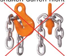
auffliegen. Zurrmittel dürfen nicht ungeschützt über scharfe Kanten gespannt und nicht über scharfe Kanten gezogen werden.
