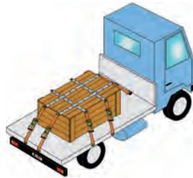
Schrägzurren in Längs- und Querrichtung
